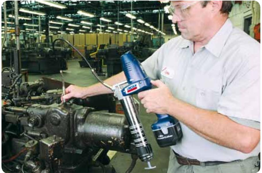
moyenne, soit le flux de lubrifiant est moins élevé, mais à haute pression (pression de service de 482 bars\*). Grâce au dispositif intégré de contrôle de course, le débit total peut être facilement mesuré.
