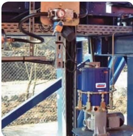
Le système de répartition progressif permet de desservir jusqu'à une centaine de points. Il est ainsi possible, sur de longues chaînes, de placer plusieurs pinceaux afin d'assurer un apport suffisant en lubrifiant.
