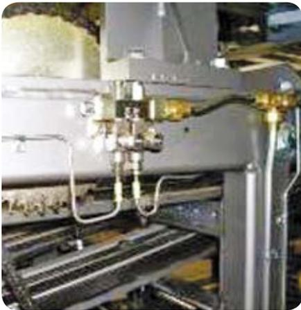
*Les distributeurs de graisse SL-32 en acier inoxydable sont utilisés pour éviter la corrosion due aux opérations journalières de rinçage qui font partie des mesures de maintenance dans cette entreprise de produits alimentaires.*
