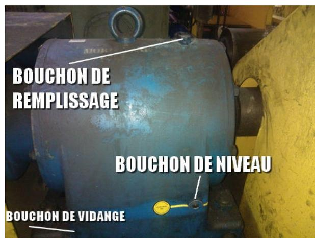
**Améliorations :** un réducteur peut être équipé d'une vanne « quart-de-tour » vissée dans l'orifice de vidange. Elle permettra d'optimiser et faciliter l'évacuation de l'huile usagée par écoulement ou aspiration. Les vannes « quart-de-tour » seront équipées d'un bouchon afin d'assurer une sécurité supplémentaire contre les fuites et ouvertures involontaires.
